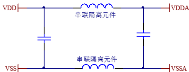
图 100 数字和模拟电源隔离示意图
